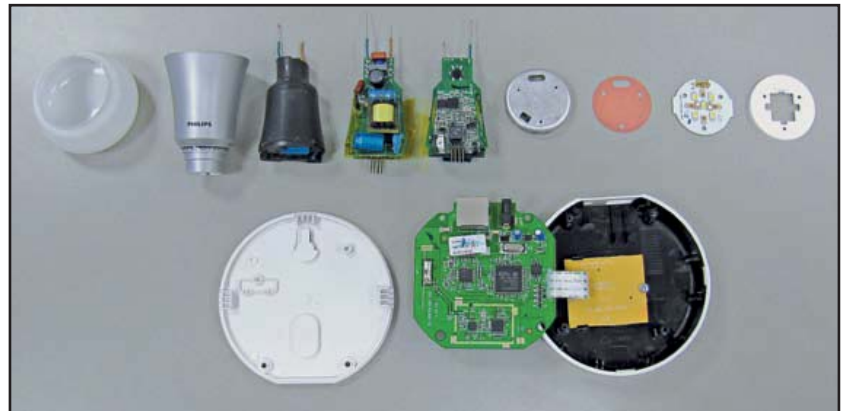
Bild 1. hue komplett zerlegt. In der oberen Reihe sieht man die Einzelteile einer Lampe und darunter die Bridge.
