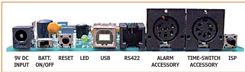
Bild 7. Ansicht der beeindruckenden Reihe von Anschlussmöglichkeiten auf der Rückseite des Weckers.
